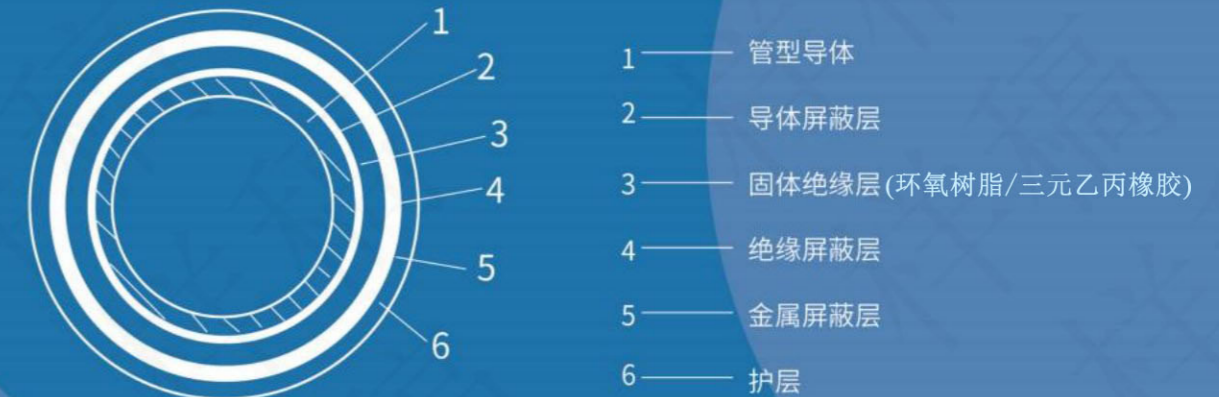
• 固体绝缘管型母线的本体示意图
